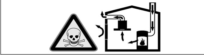
Hava dolaşımli ateşlikler (örneğin gaz, yağ, odun veya kömürle çalışan sobalar, şöbenler, su ısıtıcıları) yanma havasını kurulum yerinden alırlar ve atık gazı bir atık gaz sistemi (örneğin baca) kanalıyla dışarıya aktarırlar.
